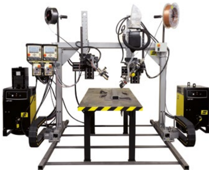
Urządzenie Mechtrac wyposażone w głowice spawalnicze A2, sterownik procesu PEK oraz źródła prądu LAF 631
